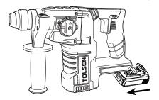
Per rimuovere il pacco batteria, farlo scivolare dallo strumento facendo scorrere il pulsante sulla parte anteriore della cartuccia. Per installare la batteria eseguire l'operazione inversa.
