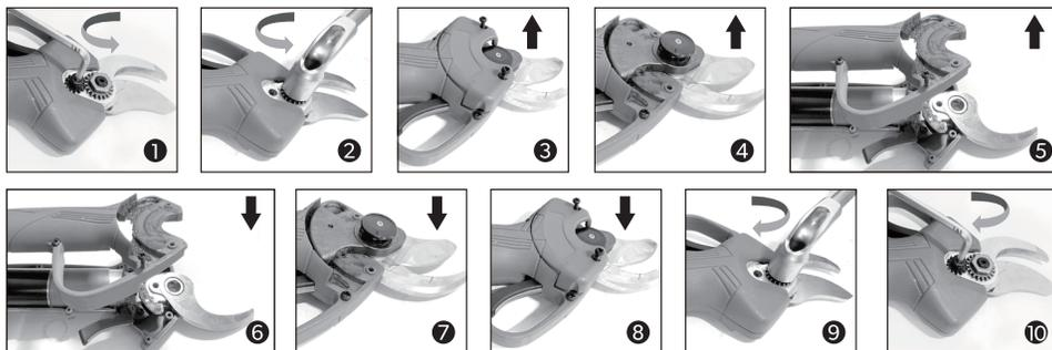
\*Le lame fisse e mobili possono essere sostituite singolarmente; non preoccupatevi dell'apertura della lama di ricambio, l'apertura tornerà automaticamente alle dimensioni normali all'accensione dopo aver completato la sostituzione delle lame.
