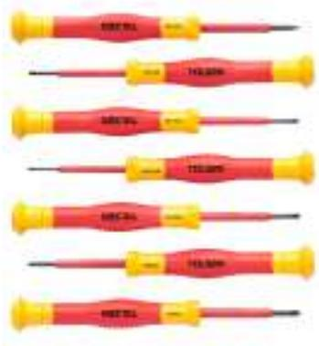
Contenuto: cacciaviti a taglio di precisione isolati: 1,5 \* 0,23 \* 50 mm; 1,8\*0,30\*50 mm; 2,0\*0,40\*50 mm; 2,5\*0,40\*50 mm; 3,0\*0,50\*50 mm; Cacciaviti phillips di precisione isolati: PH00\*50mm; PH0\*50mm; Lama in materiale S2 certificata VDE/GS, Impugnatura realizzata secondo EN60900
